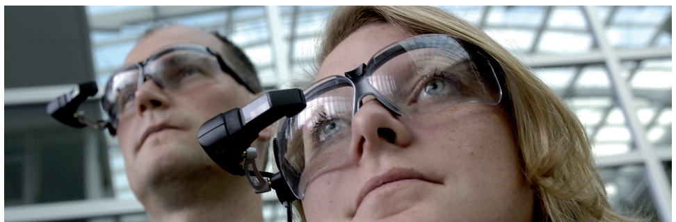
„Head-Mounted-Display“ (kleiner Computer, der als visuelles Ausgabegerät dient), Quelle: TZU/MRC.
