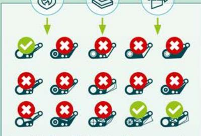
Anschließend führt das Programm virtuelle Tests durch, um die Widerstandsfähigkeit des Schwingarms zu prüfen. Dabei beachtet es auch, welchem Druck oder welcher Hitze der Schwingarm in der weiteren Verarbeitung standhalten muss.
