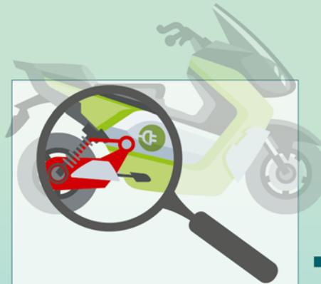
Die Herstellerin identifiziert ein Bauteil des Motorrads, an dem sie Gewicht sparen möchte: Den Schwingarm, der das Hinterrad mit dem Motorradrahmen verbindet.
