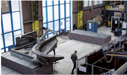
Abbildung 9: a) Produktionsprozess einer additiv gefertigten Fußgängerbrücke aus Stahl mit einem Schweißroboter (Bildquelle: Oliver de Gruijter, MX3D), b) Fertiggestellte Brücke bei einem Test in Amsterdam (Bildquelle: Tim Geurtjens, MX3D).
