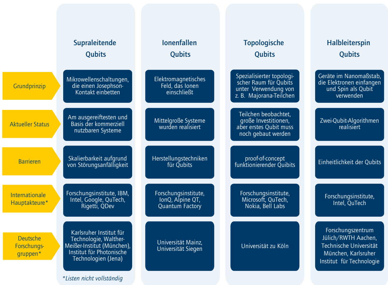
Abbildung 20: Übersicht über verschiedene Ansätze zur Realisierung eines Quantencomputers (Quelle: eigene Darstellung basierend auf Birch 2018)
