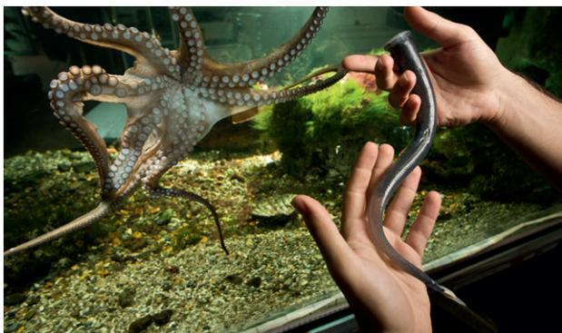
Abbildung 15: Prototyp eines tintenfischähnlichen Roboterarms zusammen mit seinem Vorbild, einem Tintenfisch (Quelle: Massimo Brega)
