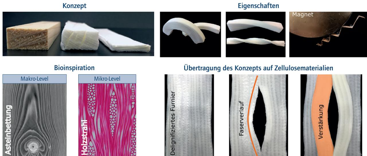
Abbildung 11: Zellulosekomposite basierend auf der Synthese von Bioinspiration und Nutzung der nachwachsenden Ressource Holz in modifizierter Form (Quelle: in Teilen aus Frey et al. 2018 und Frey et al. 2019)
