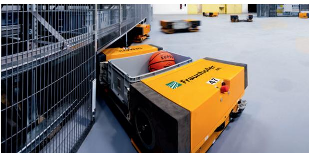
Abbildung 39: Zellulares Transportsystem mit dezentraler Multi-Agenten-Steuerung, bei der Softwareagenten die einzelnen Fahrzeuge repräsentieren und die Transportaufträge und -routen autonom verhandeln (Quelle: Fraunhofer-Institut für Materialfluss und Logistik IML)
