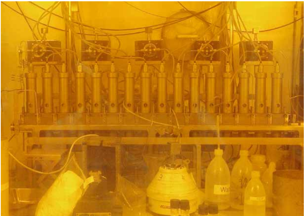
Abbildung 2: Anlage zur Durchführung von hydrometallurgischen Trennprozessen im Labormaßstab in einer Heißen Zelle am JRC-ITU (Institut für Transurane)
