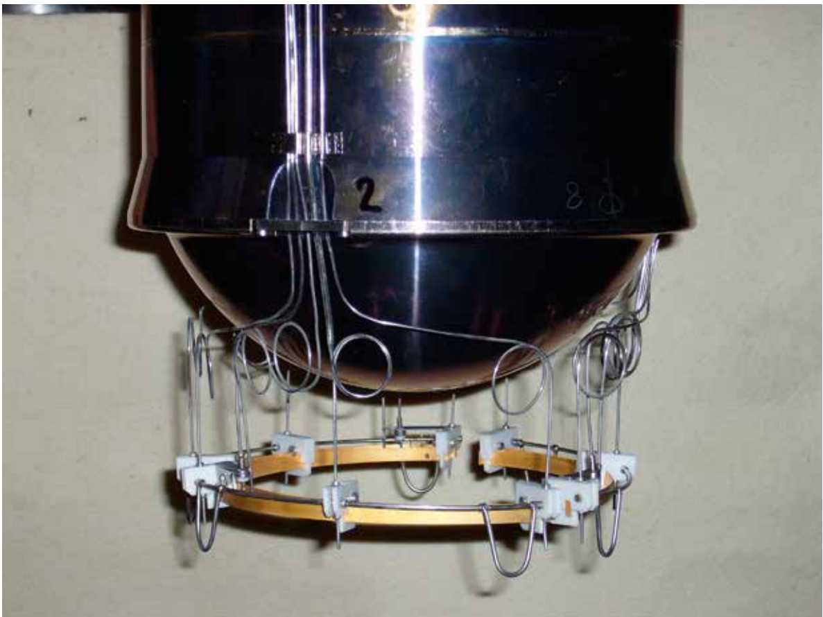
Abbildung 4: Strahleintrittsfenster des MEGAPIE Targets mit Leckagedetektorsystem vor dem Einsatz am HIPA (High Intensity Proton Accelerator) Beschleuniger am Paul Scherrer Institut in der Schweiz 175
