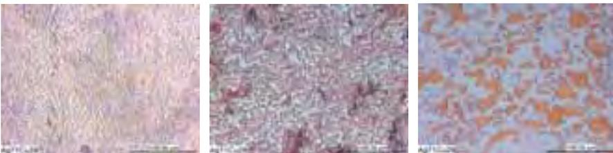
Abb. 14: Unerwünschte Zwischenschicht zwischen Substrat und Lot (aus [9])
