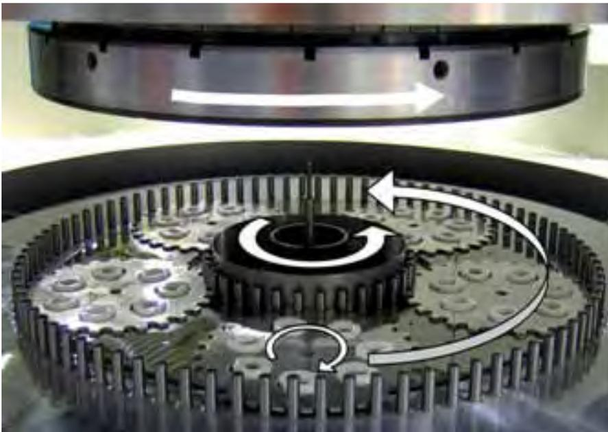
Abb. 4: Bahnformklassen in Abhängigkeit vom Drehzahlverhältnis
